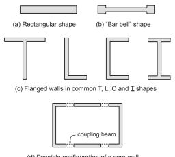
(d) Possible configuration of a core-wall
